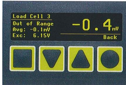
Die Ausgänge der einzelnen Wägezellen lassen sich auf Maximum und Minimum überwachen.
